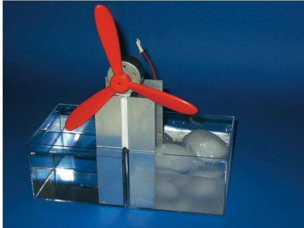
Abbildung 3.1: Mit einem Peltier-Element kann ein elektrischer Strom erzeugt werden ([www.conrad.ch](http://www.conrad.ch))
